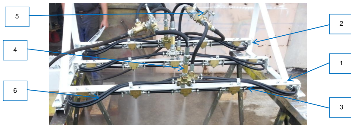
Rys. 11. Zespół zraszający podczas prób ruchowych u producenta [7]
