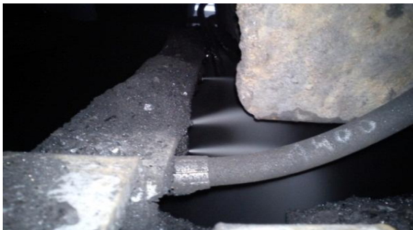
Rys. 8. System wytwarzający strumienie powietrzno-wodne, podczas prób [7]
